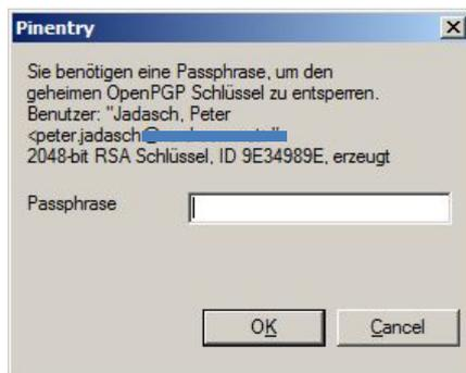
Nachdem geklärt ist, wie genau der Schlüssel geprüft wurde, wird mit OK die Eingabe der eigenen Paßphrase angefragt. Danach ist der Schlüssel signiert. Dies ist überprüfbar, wenn der entsprechende Schlüssel markiert ist und mit der rechten Maustaste das Kontextmenü aufgerufen wird. Dort ist der letzte Menüpunkt Schlüsseleigenschaften.
